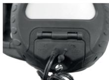
Зарядка аккумуляторной батареи, установленной в приборе
