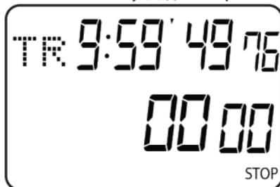
При нажатии на кнопку (2), прибор перейдет в режиме обратного отсчета времени. В первой строке дисплея будет отображаться время обратного отсчета, а во второй строке – количество циклов обратного отсчета.
